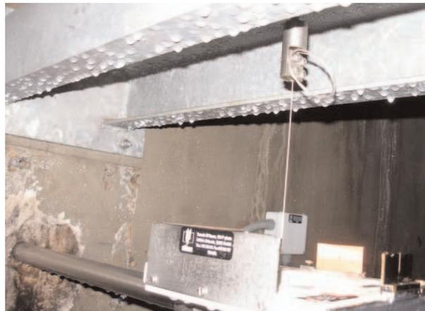
Fig. 11. Ejemplo de problemas de condensación en equipos de medida, incluida por Gil, Arguedas y G. Membrillera, en la R26.
