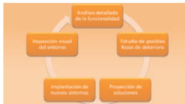
Fig. 12. Proceso de mantenimiento de sistemas de auscultación en presas, incluida por Gil, Arguedas y G. Membrillera, en la R26.
